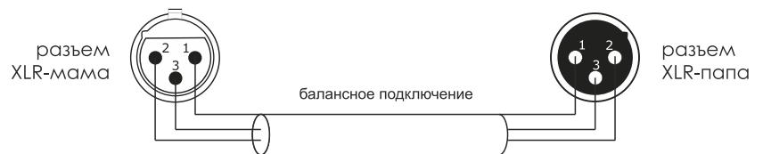
3. Балансный линейный вход для источников линейного сигнала.
