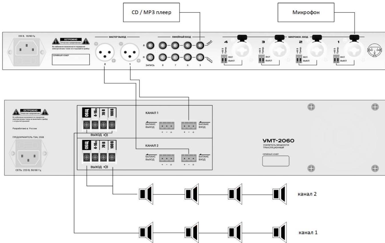
\* аналогичное подключение производится при работе в режиме 70в и 4-16 Ом
