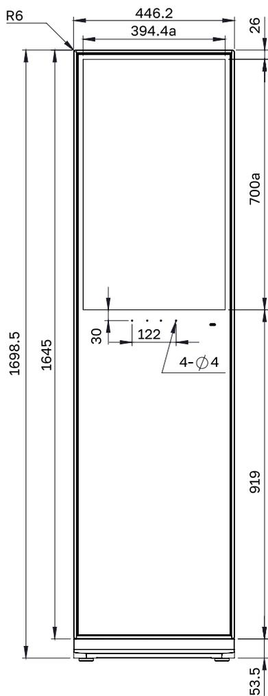
**СХЕМА ДИСПЛЕЯ (ВИД СЗАДИ)**
