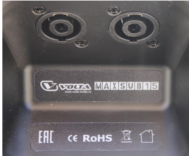
Обратите внимание, что на терминале АС расположены 2 разъёма Speakon. Любой из них служит для подключения АС к усилителю. Второй предназначен для параллельного подключения дополнительной акустической системы. Не рекомендуется (хотя это возможно) использовать в качестве дополнительной АС другой конструкции и сопротивления, так как это может привести к различным негативным последствиям. Проконсультируйтесь по данному вопросу в авторизованных центрах VOLTA.
