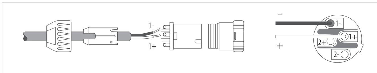
Collegare il conduttore positivo (uscita "+" dell'amplificatore) al contatto 1+ del connettore SPEAKON; collegare il conduttore negativo (uscita "-" dell'amplificatore) al contatto 1- del connettore SPEAKON.
