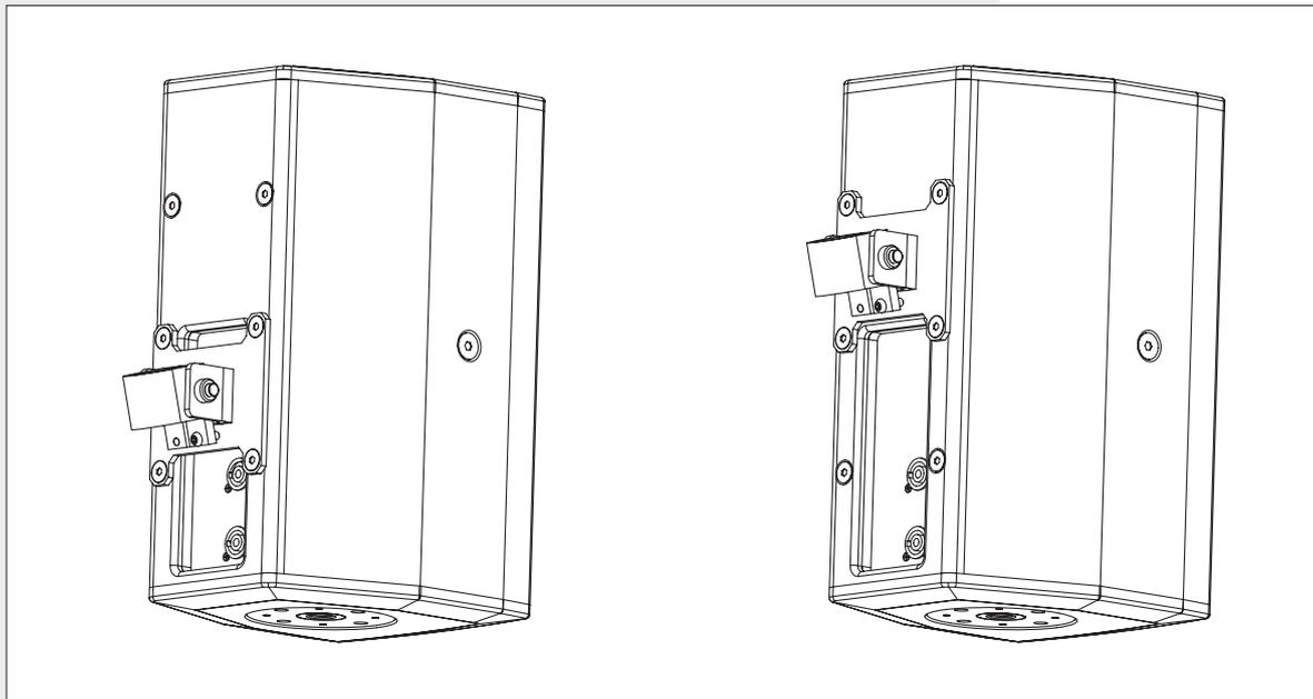
Per posizionare l'accessorio al centro (permettendo così anche un'installazione orizzontale equilibrata del diffusore), occorre aggiungere le due barre in dotazione.
