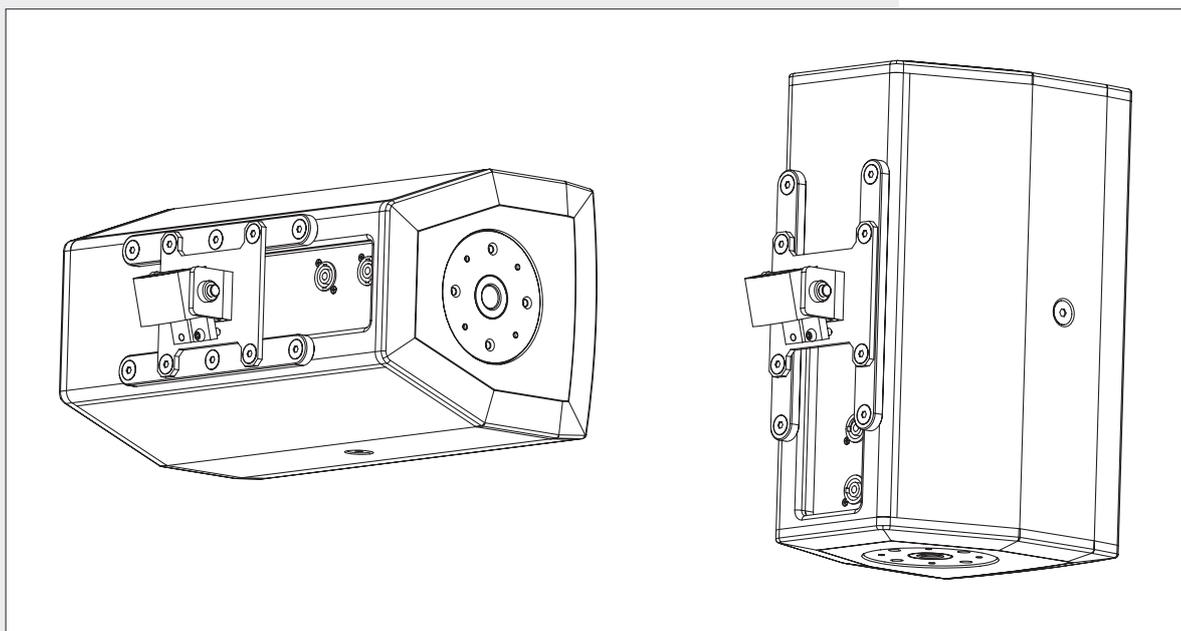
I modelli C3110 hanno sul retro 8 fori filettati (anziché 6), permettendo così direttamente (senza barre aggiuntive) l'installazione centrale dell'accessorio AC WM-C.
