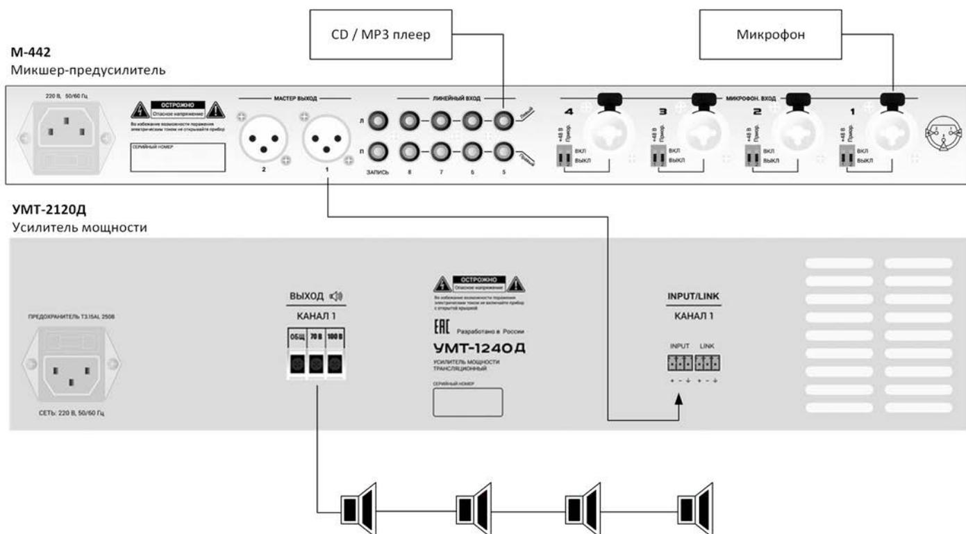
\* аналогичное производится подключение при работе в режиме 70 В (используйте соответствующую клемму).
