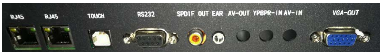
Второй блок интерфейсов на задней панели Prestel TSP-4K652
