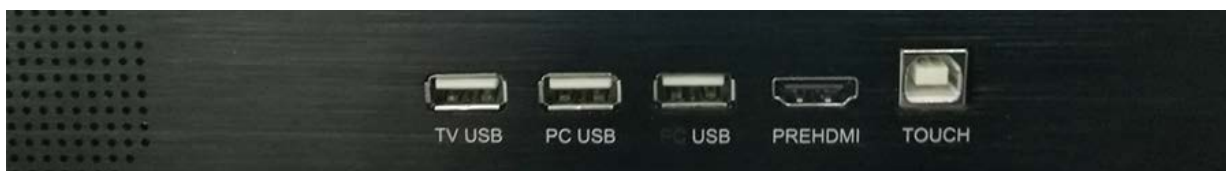
Интерфейсы на задней панели Prestel TSP-4K652
