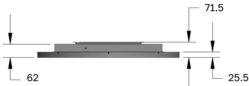
**СХЕМА ДИСПЛЕЯ (ВИД СНИЗУ)**
