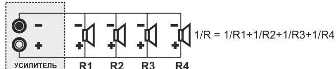
Также допустимо использование последовательно - параллельного соединения, но это не всегда удобно при монтаже кабельных трасс. Следите за тем, чтобы суммарное сопротивление акустических систем на каждом канале усилителя оставалось в диапазоне **4 - 8ohm**.
