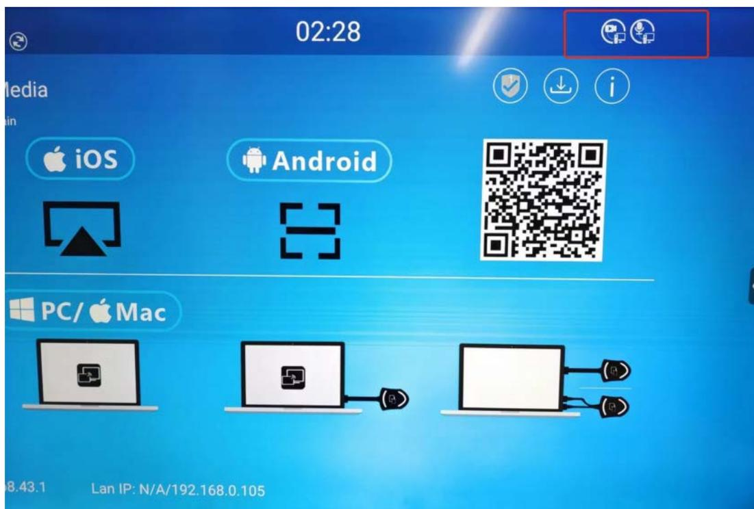
Когда USB-концентратор подключен к беспроводному источнику, значки камеры и микрофона выглядят следующим образом:
