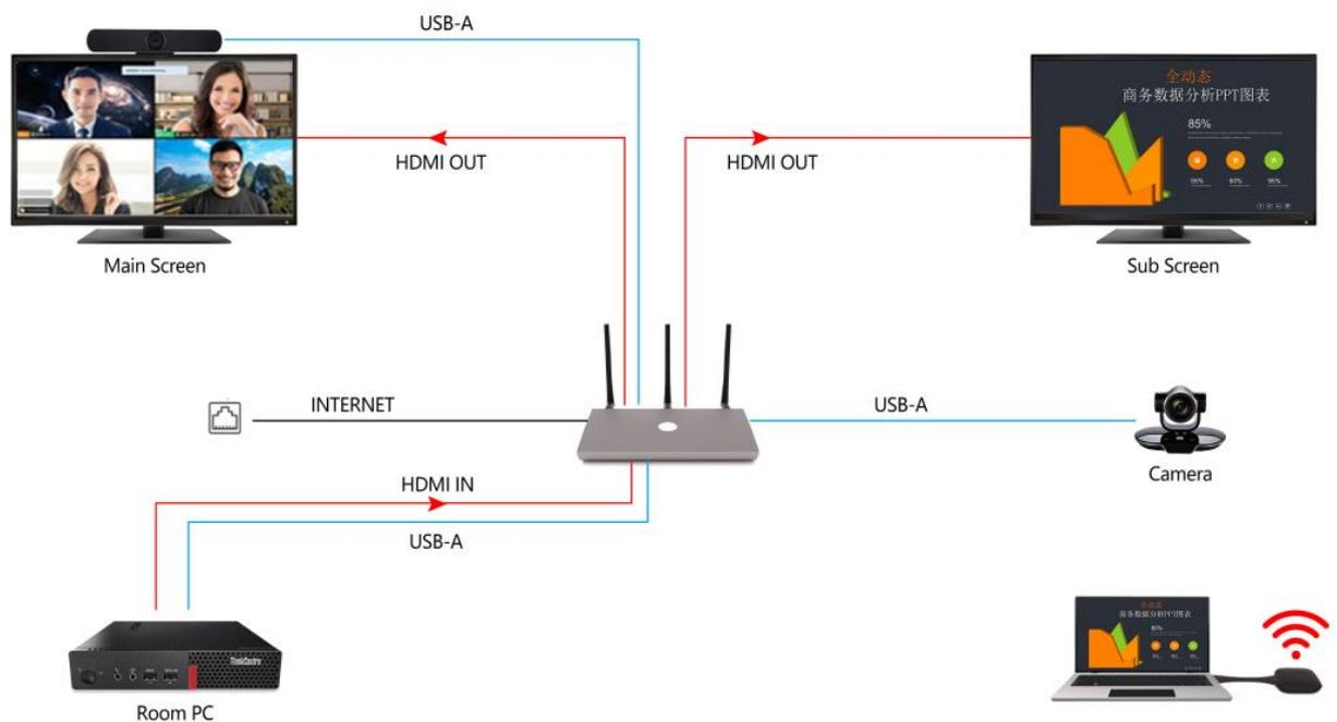
7.1 Подключите комнатный ПК к BYOM-2 с помощью кабеля HDMI и USB.
