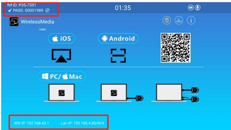
2.22 Для сети варианта 1 используйте IP-адрес Wi-Fi, указанный на домашней странице, для входа в веб-интерфейс. Для сети варианта 2 используйте IP-адрес LAN, указанный на домашней странице, для входа в веб-интерфейс.
