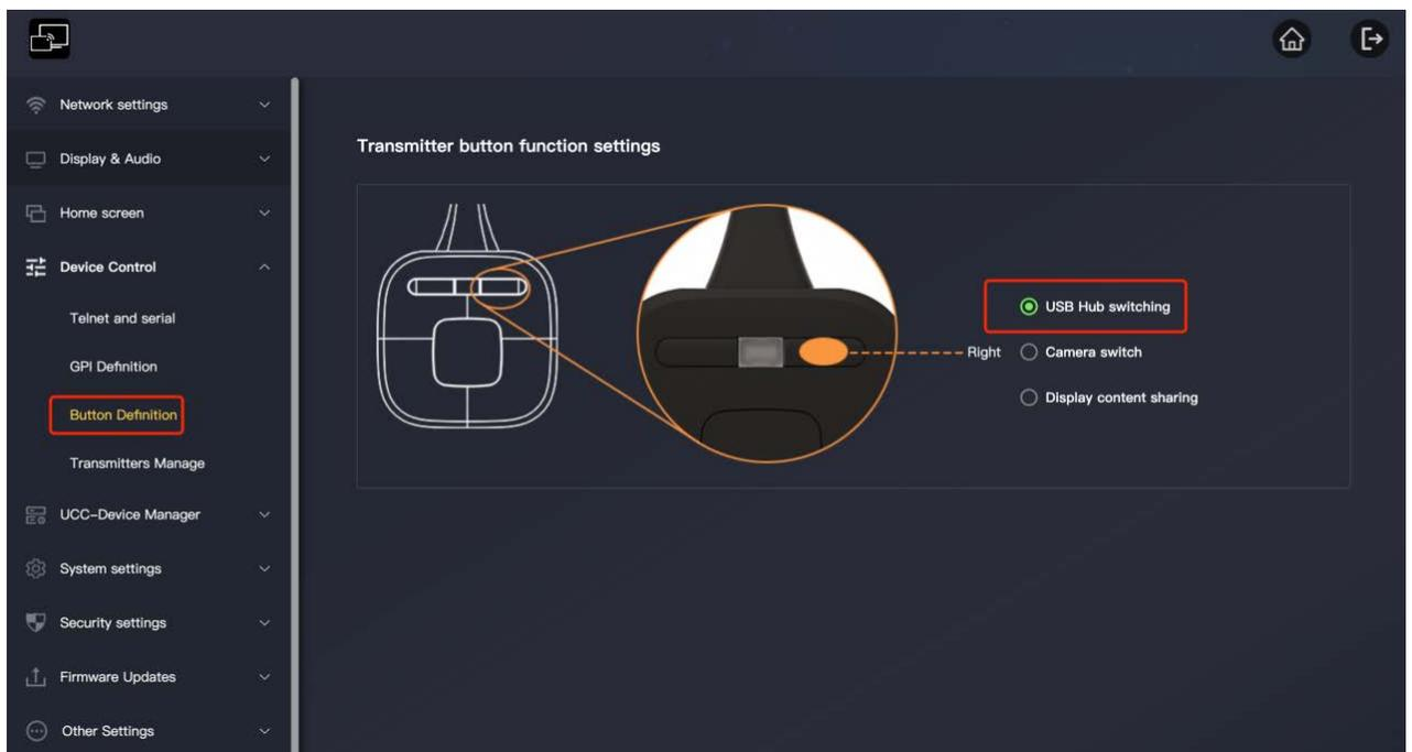
Нажмите правую кнопку на ключе, чтобы переключить USB-концентратор между USB-B и беспроводным подключением.
