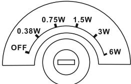
Каждое положение аттенюатора соответствует определенной мощности - 0,38 / 0,75 / 1,5 / 3 / 6W в 100V режиме. Шестое положение аттенюатора отключает громкоговоритель. Благодаря этому данную модель удобно использовать например в отдельных офисных кабинетах, учебных классах, гостиничных номерах, административных помещениях и так далее.
